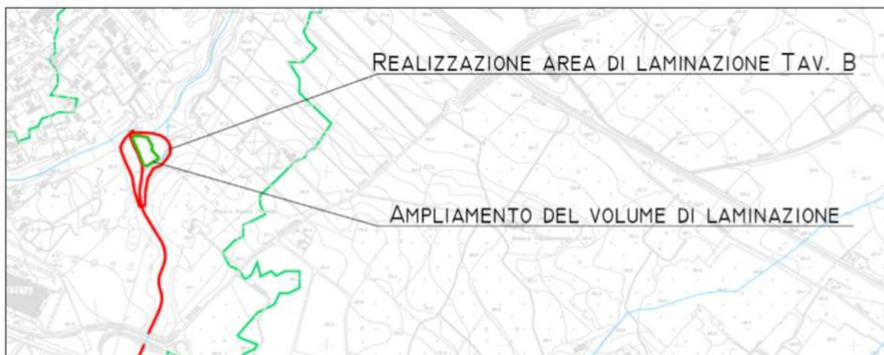
*Figura 23 Corografia con indicazione dell'area di laminazione in progetto.*
