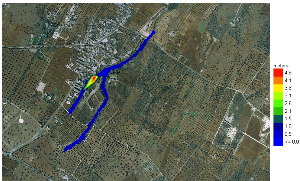
Fig. 6: Planimetria Flo 2D con indicazione delle aree interessate dal passaggio della piena – Tr 500 anni.
